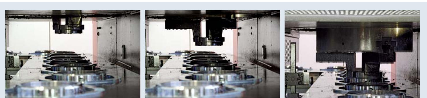
Le mandrin accomplit un cycle entier en 1 ou 2 minutes de l'intérieur vers l'extérieur de la machine. L'amenage dépose un écrou fileté fini et met en position la prochaine pièce à travailler.
