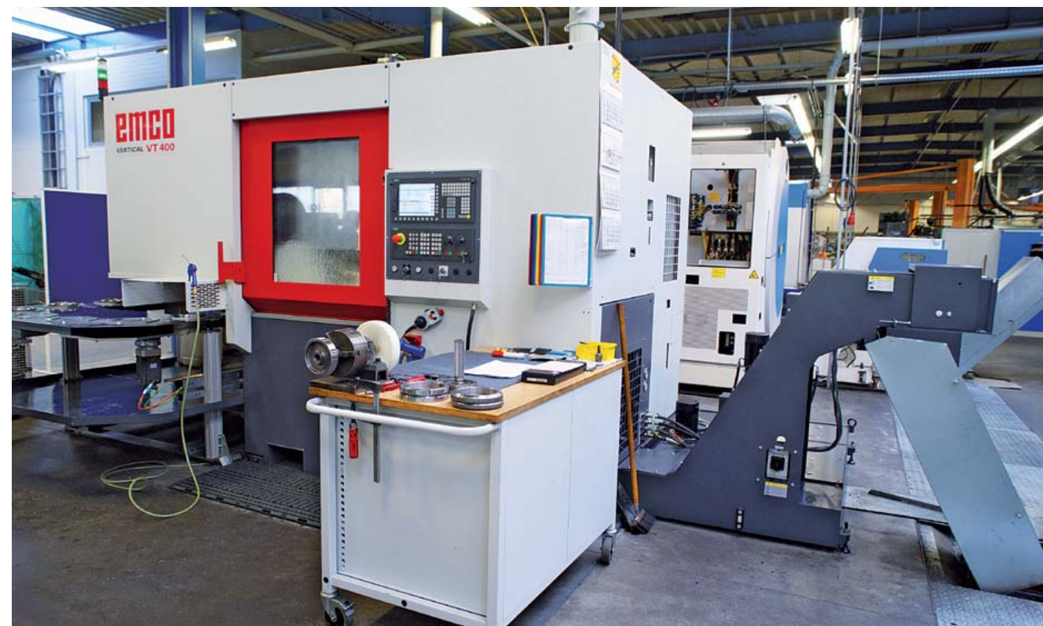
Sur la gauche du VERTICAL VT 400, l'amenage apporte les pièces à travailler, ainsi que celles qui sont terminées. L'évacuation des copeaux est sur la droite.
