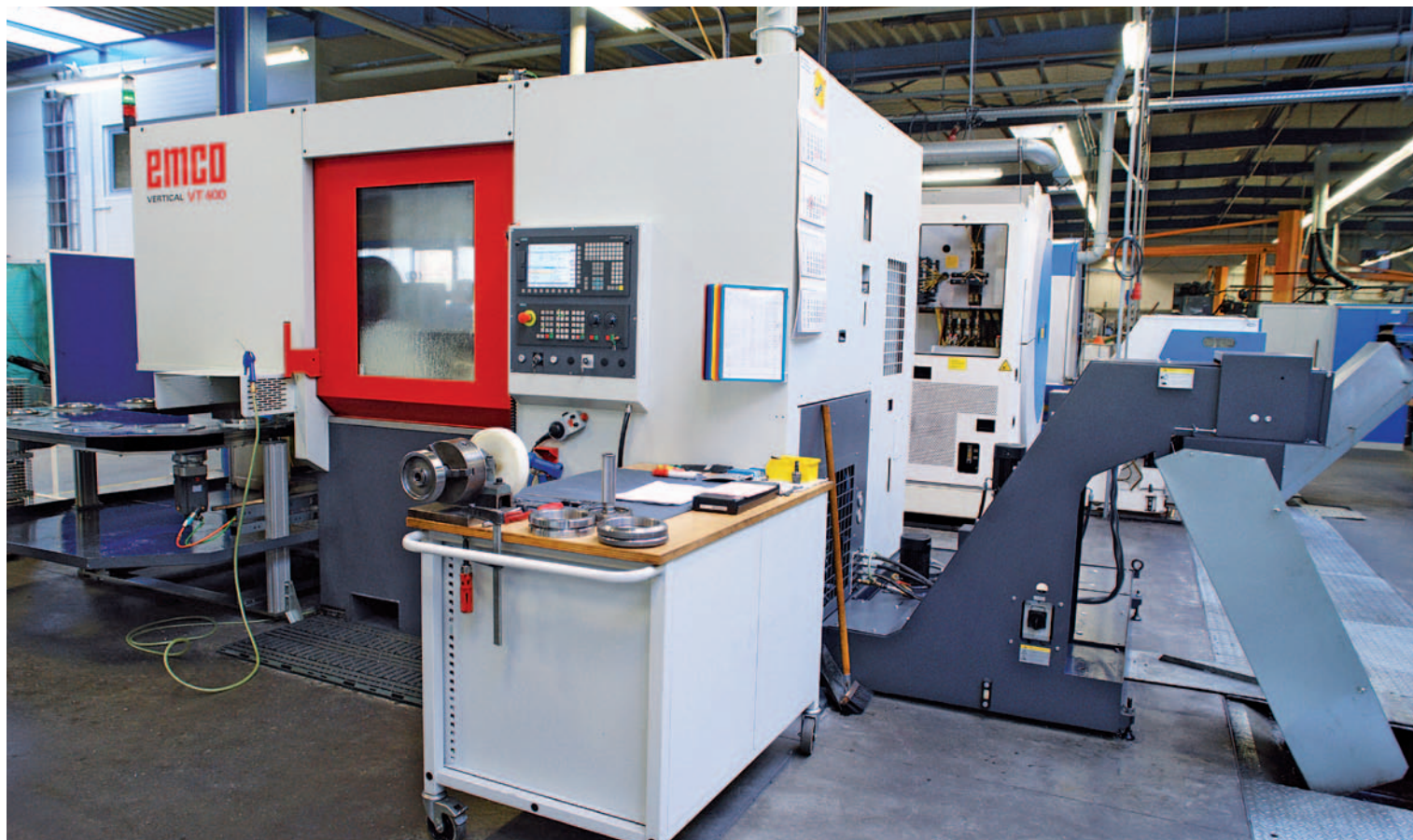
A sinistra del VERTICAL VT 400, scorre lentamente il nastro trasportatore dei pezzi in lavorazione e finiti, a destra, si trova lo smaltimento dei trucioli centralizzato.
