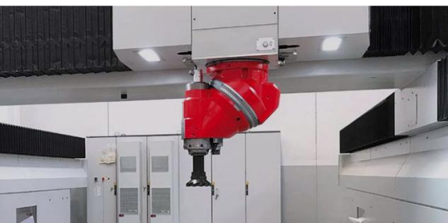
Chariot de l'axe Z intégré dans la traverse de la machine, sa structure garantit les meilleurs résultats de rigidité et dynamique.
