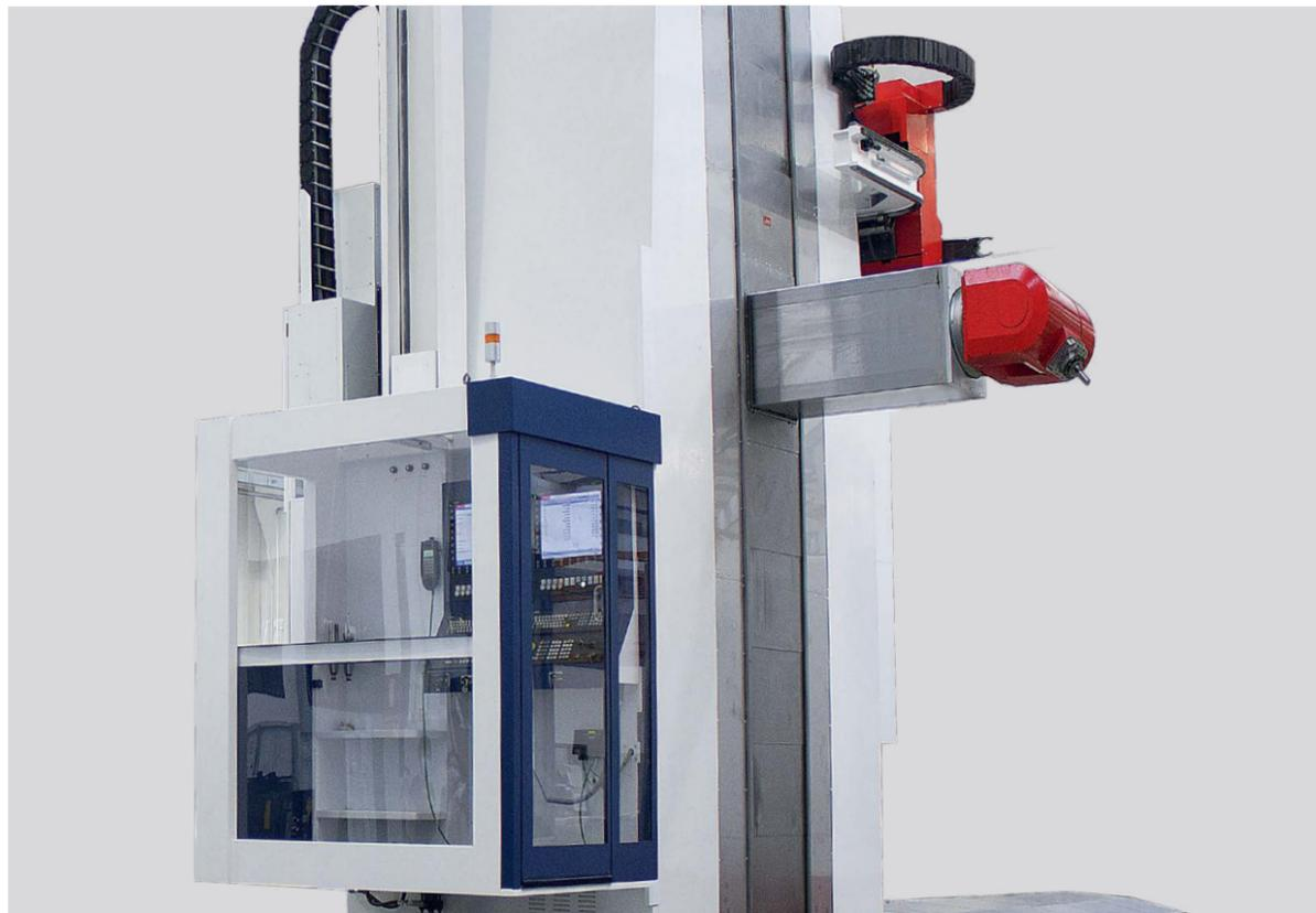
POMO e POVT Pedana operatore con corsa verticale (fino a 2500 mm) e trasversale (fino a 800 mm).
