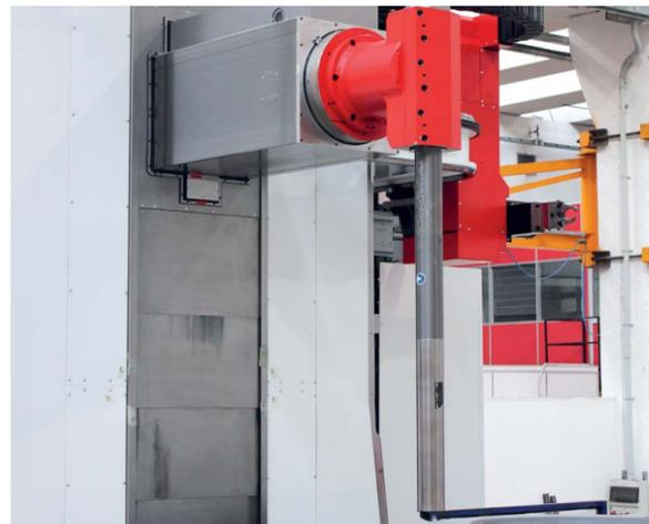
Testa di tornitura per il supporto di una barra di alesatura speciale: 120 mm diametro, lunghezza fino a 1500 mm per operazioni di tornitura fino a 1000 mm di profondità.
