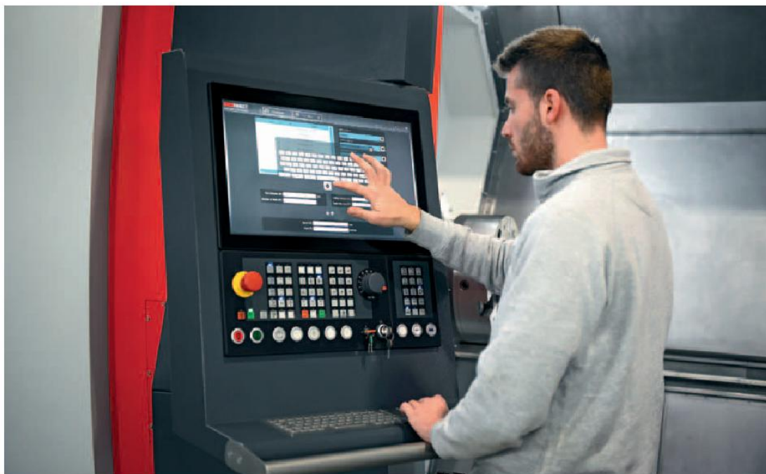
L'interfaccia utente emcoCONNECT è predisposta di serie su tutte le macchine Emco con CNC Siemens 840D sl.
