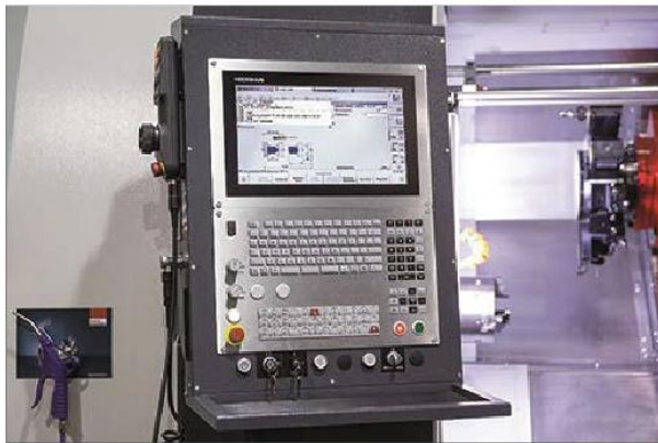
I modelli EMCOTURN E45 ed E65 sono ora equipaggiati con CNC HEIDENHAIN.
