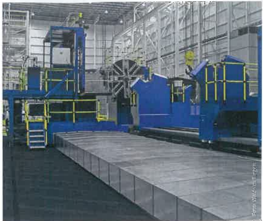
Die Rekordmaschine von Waldrich Siegen heißt Profiturn H. Die Drehmaschine mit 7.000 mm Drehdurchmesser fertigt in den USA Turbinenläufer und Generatorwellen.
