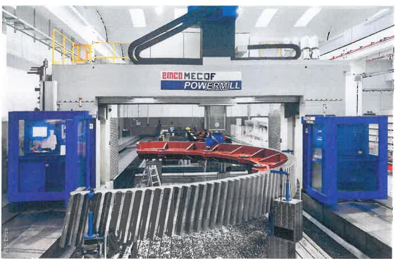
Das Fräszentrum Powermill von Emco hat einen Fahrweg von 32.000 mm in der X-Achse und steht beim italienischen Kunden Rival.
