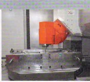
Das Bearbeitungszentrum Umill 1800 von Emco bei der 5-Achs-Simultan-Bearbeitung einer Spritzgußform. Das BAZ verfügt über einen Achsenverfahrweg von 1.800 x 2.150 x 1.250 mm.
