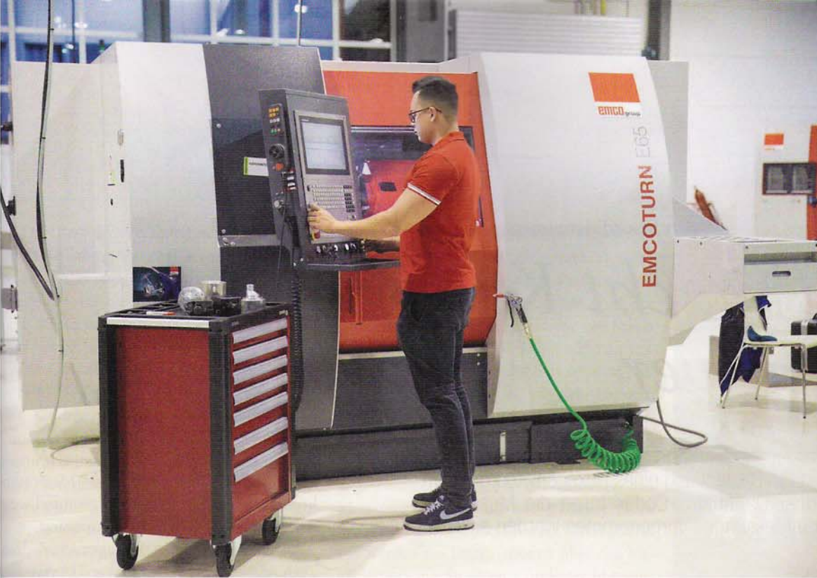
Die Steuerung CNC Pilot 640 eignet sich für Drehmaschinen wie die Emcoturn-Drehzentren, die ihre Stärken im Werkstatteinsatz haben.
