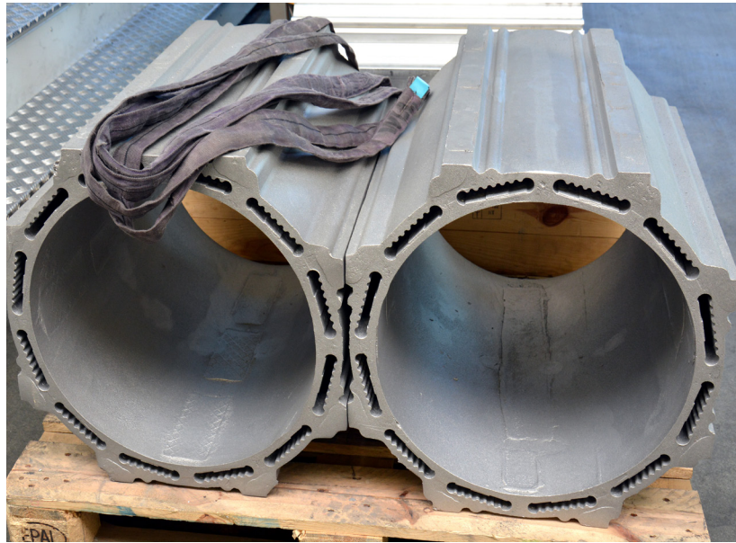
Gab den entscheidenden Anstoß: diese allseitig innen und außen zu bearbeitenden Gehäuse für Lkw-Elektromotoren aus Aluminium-Sandguss brachten Schwarz zur kombinierten Fräsdrehbearbeitung auf der Umill 1800 von Emco; statt zuvor in zehn sind es nun nur noch zwei Aufspannungen vom Rohteil (links) zum Fertigteil (rechts)
