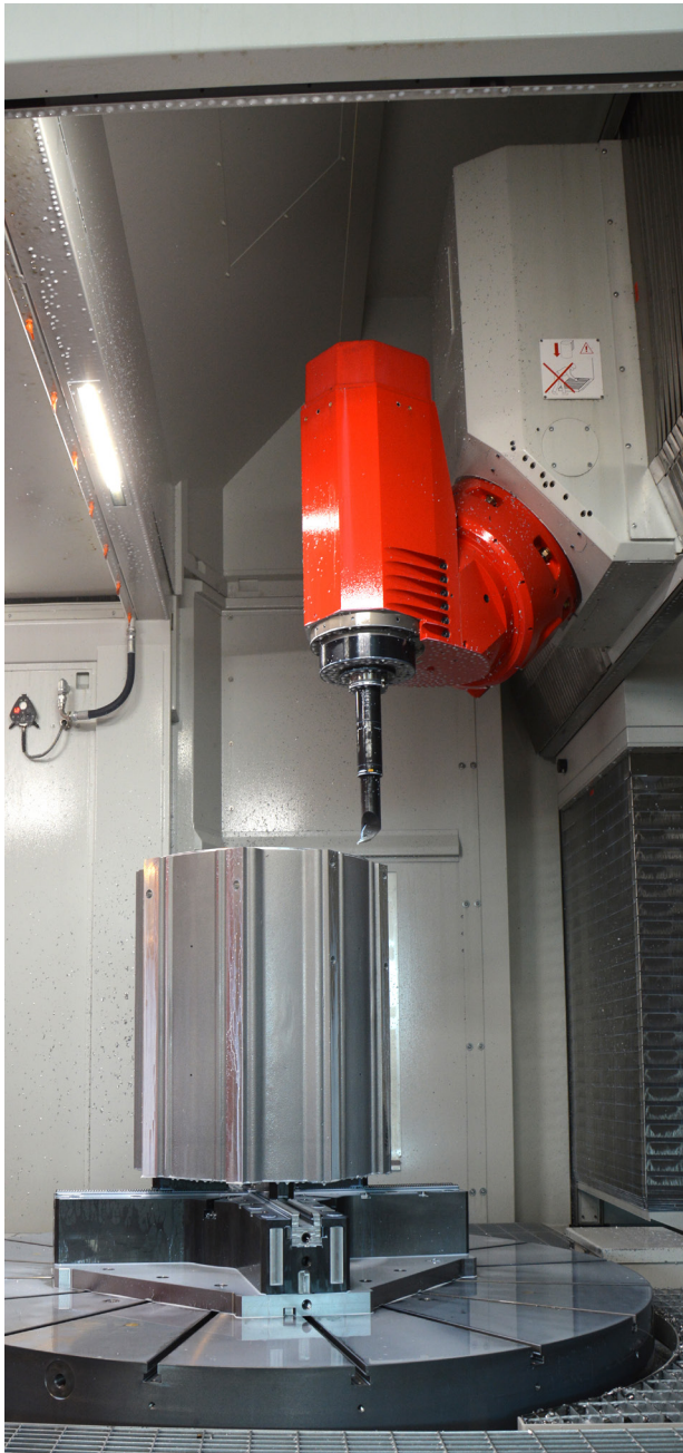
Blick in den Arbeitsraum des 5-Achs-Fräsdrehzentrums Umill 1800 von Emco bei Schwarz Elektromotoren: Auf dem mit bis zu 250 min -1 rotierenden NC-Dreh-Rundtisch können Bauteile – hier das aktuell größte Elektromotorengehäuse von Schwarz – wie auf einer Karusselldrehmaschine auch drehend bearbeitet werden.
