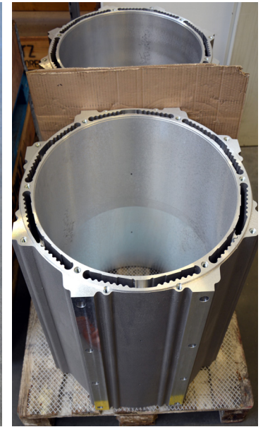
Gab den entscheidenden Anstoß: diese allseitig innen und außen zu bearbeitenden Gehäuse für Lkw-Elektromotoren aus Aluminium-Sandguss brachten Schwarz zur kombinierten Fräsdrehbearbeitung auf der Umill 1800 von Emco; statt zuvor in zehn sind es nun nur noch zwei Aufspannungen vom Rohteil (links) zum Fertigteil (rechts)
