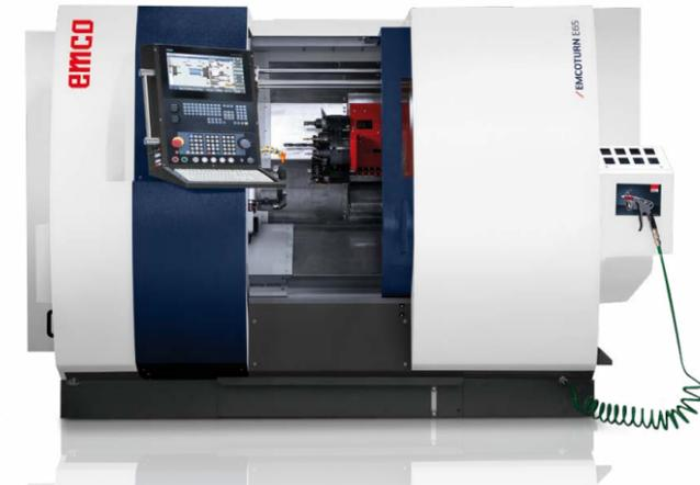
Das CNC Drehzentrum EMCOTURN E65 produziert für GF Casting Solutions vorwiegend Schraubkerne. So gelingt es die interne Ersatzteilproduktion auf hohem Niveau und in hoher Geschwindigkeit zu bewerkstelligen.
