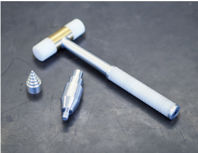
Drei typische Probewerkstücke für die Zerspanausbildung im ersten Lehrjahr.
