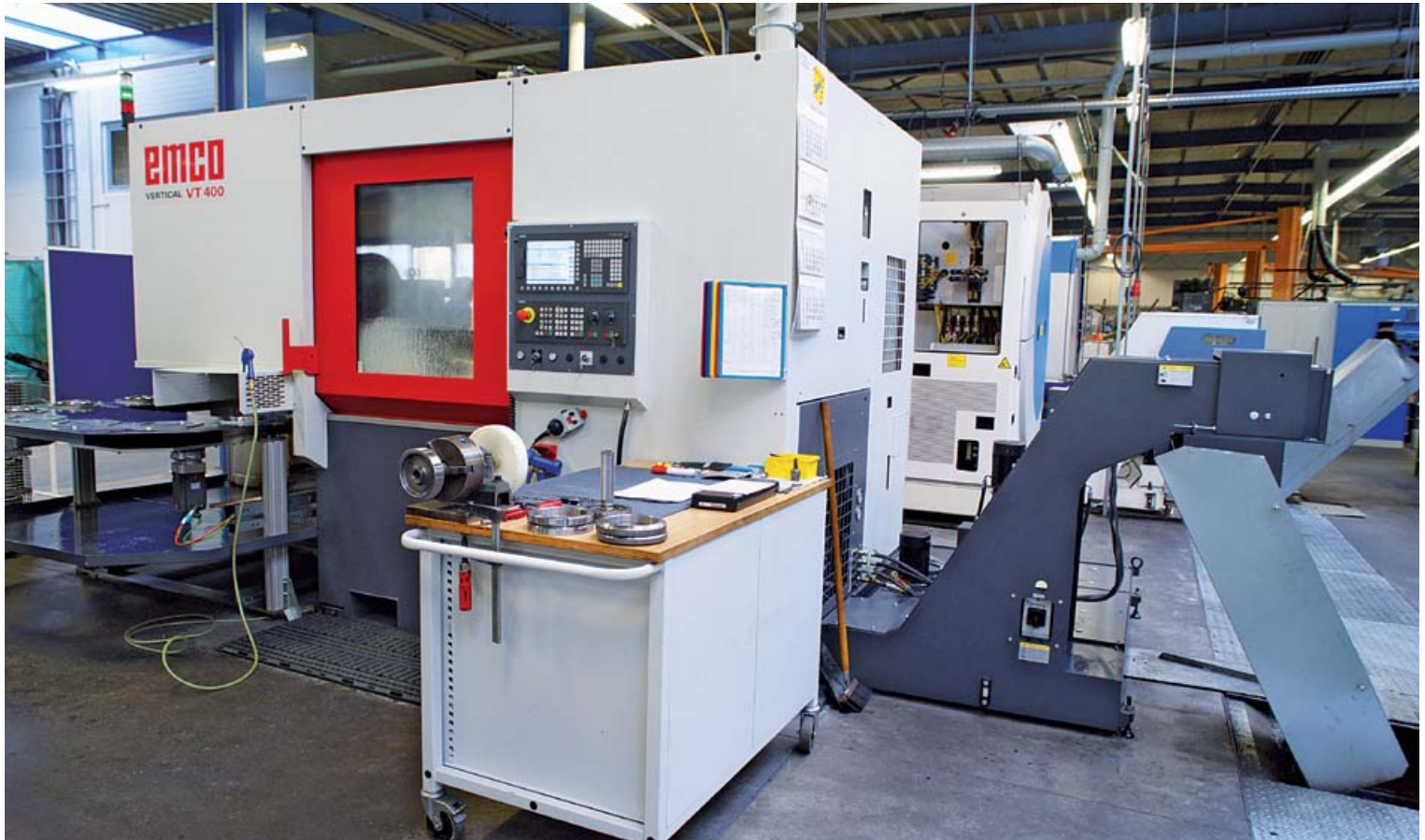
Links von der VERTICAL VT 400 fördert das Schleppprahmenband die zu bearbeitenden sowie die fertigen Teile, rechts befindet sich die zentrale Späne-Entsorgung.
