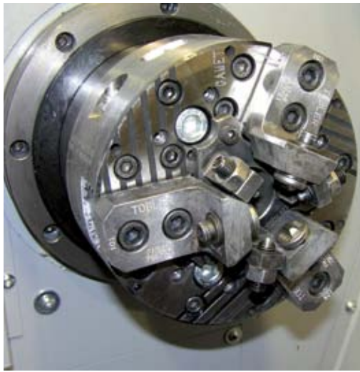
Speziell an die Maße der Rohteile angefertigtes Spannfutter
