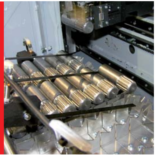
Die Antriebswellen aus Edelstahl verbinden die Elektronik mit der Mechanik der Pumpen
