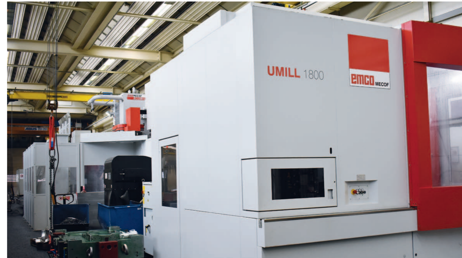
Portalfräsmaschine für die 5-Achs-Bearbeitung Umill 1800 im Einsatz beim Spritzgießwerkzeug-Hersteller HKR in Spraitbach
