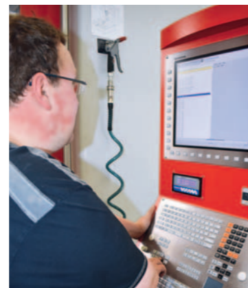
Ergonomische Gestaltung des Bedienpults mit großem 19" Bildschirm
