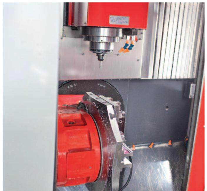
Komplettbearbeitung in einer Aufspannung mit der MAXXMILL 500 hilft bei HABICHT die Bearbeitungszeit und damit die Lieferfrist zu verkürzen, und sie gewährleistet hoch präzise Ergebnisse auch bei komplexen Werkstückgeometrien.
