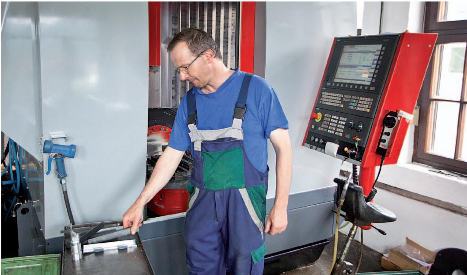
Mit dem Einsatz der MAXXMILL 500 hat sich bei HABICHT Herbert Eigentler die Bearbeitungszeit deutlich verringert. Daran hat die Komplettbearbeitung in lediglich einer Aufspannung einen wichtigen Anteil.
