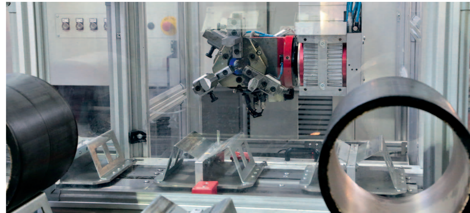
Der Portallader ist mit einem beidseitig ausgeführten 3-Backen-Greifer für Innen- und Außengriff ausgestattet und kann bis zu 40 kg schwere Werkstücke mit bis zu 120 m/min bewegen.
