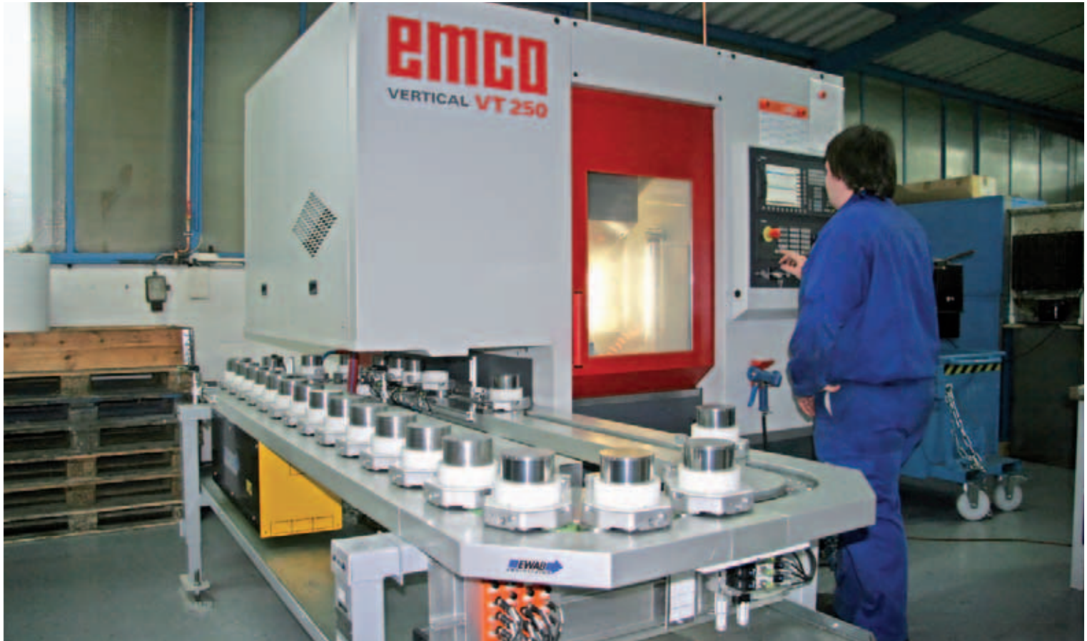
VT 250: eine außerordentlich stabile Maschine, die für die schwer Zerspänung konzipiert wurde.
