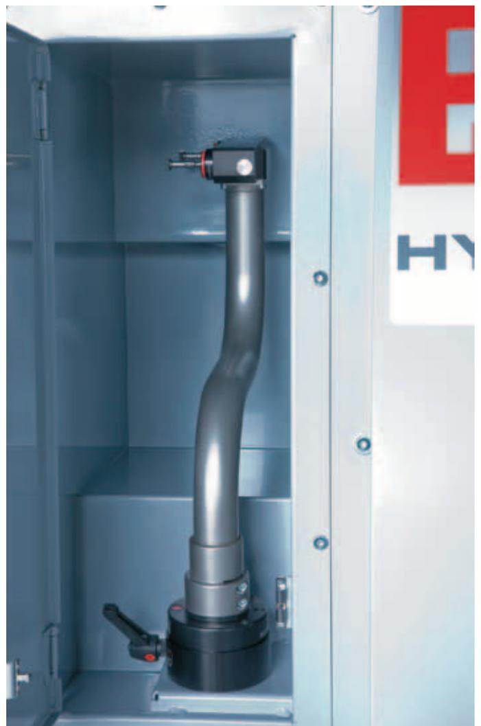
Ablage für den herausnehmbaren Werkzeugvermessungsarm
