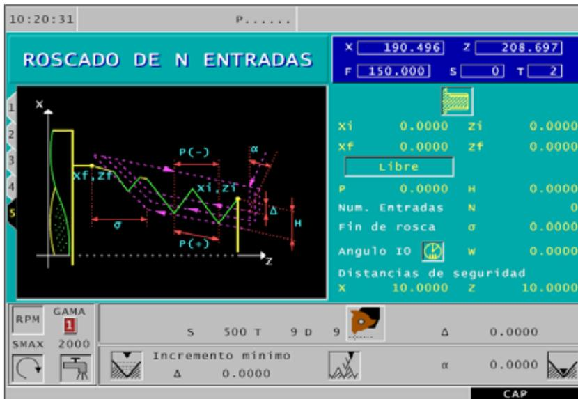
El ciclo Roscado de N Entradas permite cortar roscas exteriores, interiores y cónicas a posteriori con cualquier número de filetes.
