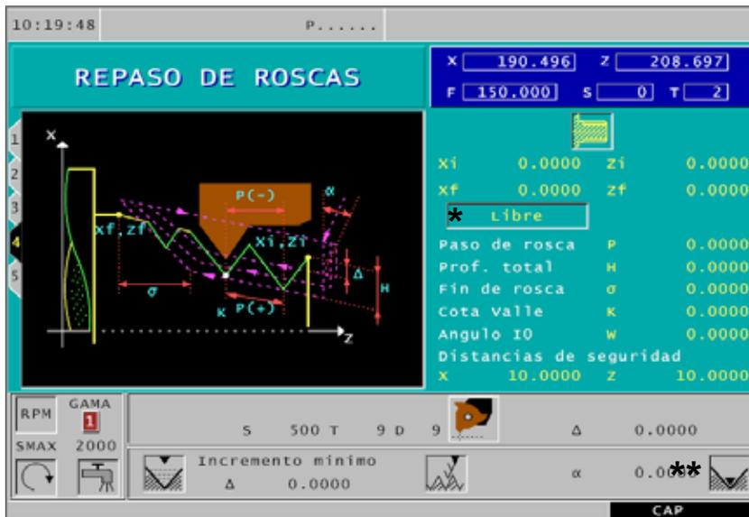
El ciclo Repaso de Rosca permite cortar roscas exteriores, interiores y cónicas a posteriori.
