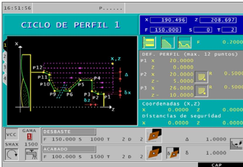
Con Ciclo de Perfil 1 se puede procesar cualquier contorno. Sin embargo, este contorno sólo puede constar como máximo de 12 puntos de posición.
