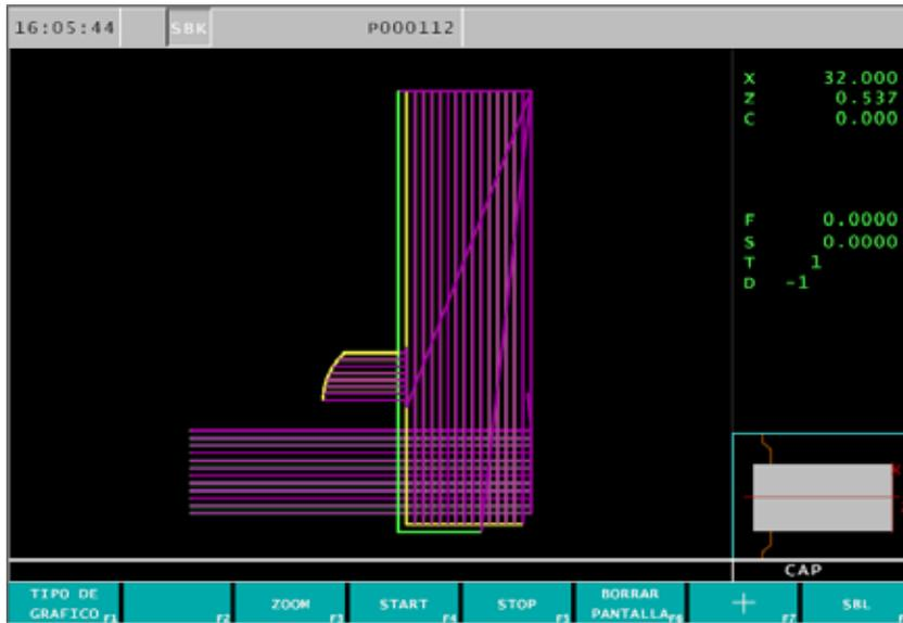
Con esta tecla Softkey, la simulación se detiene después de cada frase. La simulación puede reanudarse con la misma
