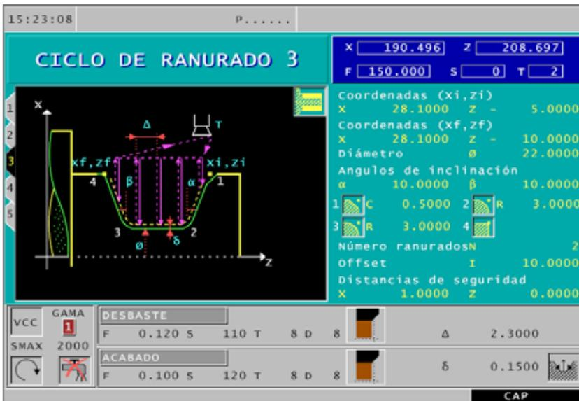
Con Ciclo de Ranurado 3 se realiza una perforación cónica a lo largo de un lado, con Ciclo de Ranurado 4 una perforación cónica en el frente.
