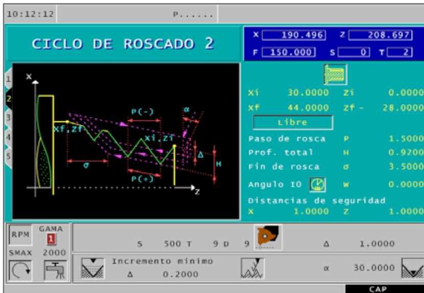
Ciclo de Roscado 2 sirve para la producción de roscas cónicas (interiores y exteriores).
