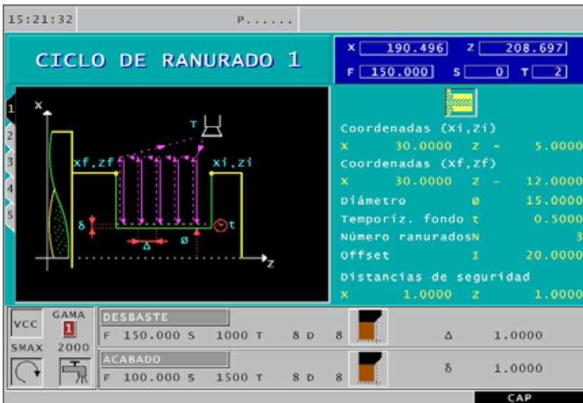
Con Ciclo de Ranurado 1 se realiza una perforación recta y a lo largo de un lado, con Ciclo de Ranurado2 una perforación recta en el frente.
