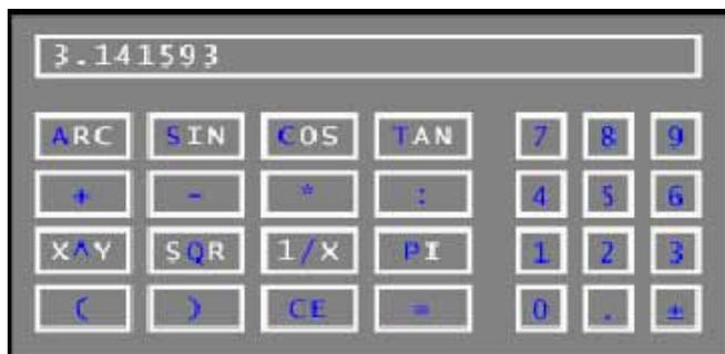
Il WinNC dispone di una calcolatrice incorporata che permette di calcolare le principali funzioni matematiche. Per lanciare e chiudere la calcolatrice, usare il tasto CALC.
