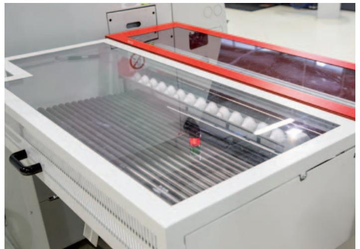
**Stockage de matériau.** La surface de stockage de matériau avec une longueur de 560 mm est disposée à l'arrière du chargeur de barres d'une manière sans influence que ce soit sur l'espace disponible. En fonction du diamètre il est possible de stocker un nombre différent de barres courtes.
