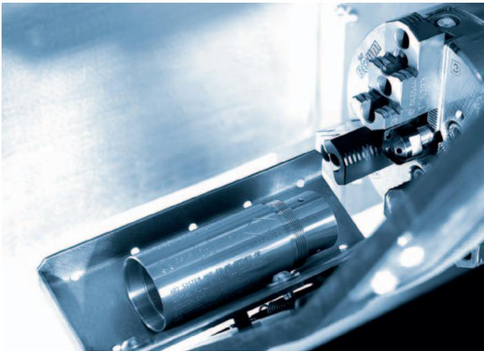
**Ramasse-pièces.** Dans l'HYPERTURN 45 le ramasse-pièces à entraînement pneumatique est contrôlé par des fonctions M. Au besoin, il traverse à l'avant de la zone d'usinage et il se déplace vers le centre de la broche. La pièce finie est retirée du dispositif de serrage et transférée dans le bac récepteur. Le ramasse-pièces alors revient à sa position initiale et la pièce est destinée dans une boîte de pièces finies ou dans un convoyeur à tapis.
