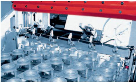
Convoyeur pour une alimentation orientée, avec une capacité remarquable de pièces.
