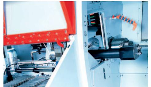
Chargement entièrement automatique des arbres. Alimentation à travers convoyeur, déchargement à travers le dispositif de ramasse-pièces.
