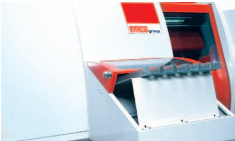
Canaux de guidage multiples pour pièces à symétrie rotative. Un capteur surveille la disponibilité des pièces pour chaque canal d'alimentation.
