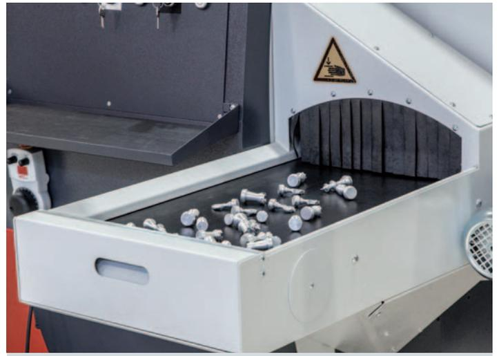
**Convoyeur pour pièces finies.** Le ramasse-pièces déplace les pièces finies sur un convoyeur avec une zone de stockage utilisable de 340 x 750 mm.
