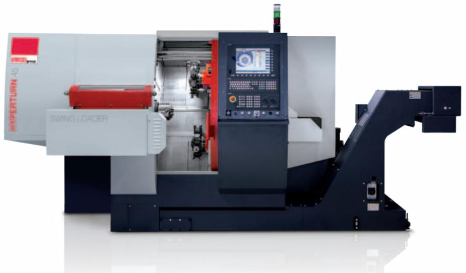
Le chargeur EMCO est un dispositif de chargement universel de pièces brutes préformées de toutes sortes. Il peut être personnalisé en fonction des besoins spécifiques du client. A cette fin sont disponibles différents systèmes de prise et de manutention. Notre méthode consiste dans la standardisation des composants et dans la personnalisation de la solution. Il en résulte un équipement sur mesure à un prix convenable.
