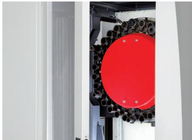
**Magazzino utensili.** Magazzino utensili con configurazione a pinze a doppio braccio per cambio utensili rapido entro i 2 secondi. La gestione utensili di tipo random permette di ridurre al massimo i tempi di cambio utensile. Grazie alla porta laterale di accesso al magazzino (2 per la lavorazione in pendolare) i pezzi possono essere preparati e controllati durante il processo di lavorazione.
