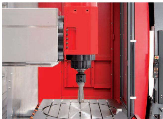
**Asse Y.** L'asse Y ha una configurazione ram. Questa soluzione costruttiva prevede l'utilizzo di guide lineari lungo tutto il ram per garantire la rigidità richiesta.
