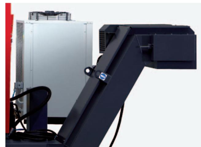
**Trasportatore trucioli a tapparella.** Il sistema di evacuazione trucioli fa defluire i trucioli sul trasportatore trucioli a tapparella, il quale li trasporta automaticamente dall'interno della macchina al contenitore esterno opportunamente previsto dal cliente.
