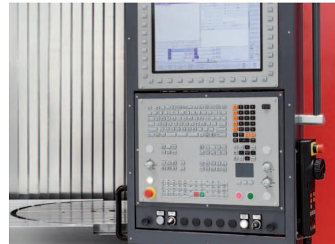
**Pannello di controllo.** Il pannello operatore può essere agevolmente spostato e ruotato in direzione dell'area di lavoro. Questo design ergonomico permette di avere le condizioni di lavoro ideali per l'operatore.
