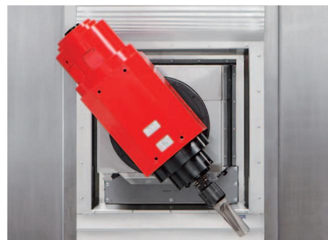
**Asse B.** L'asse B è azionato da un motore torque, in questo modo è possibile raggiungere una elevata dinamicità nella corsa dell'asse grazie al raggio basculante di +/- 120 gradi.
