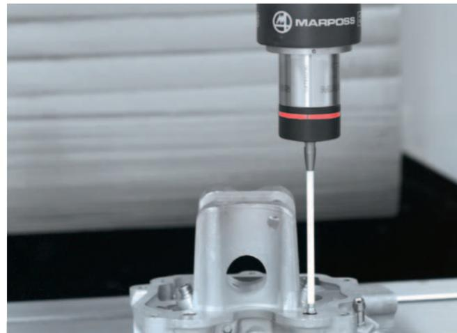
**Sistemi di misurazione.** Sistemi di misurazione utensili per la riduzione dei tempi di setup durante le operazioni di cambio utensile, inoltre misurazione pezzo per la verifica delle dimensioni o per il posizionamento degli zeri. La misurazione pezzo è radio.
