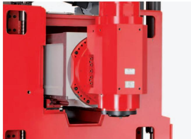
**Elettromandrino.** La macchina è equipaggiata con un mandrino raffreddato a liquido con prestazioni assolutamente convincenti. Con velocità di rotazione di 15000 giri/min, potenza di 46 kW e coppia di 170 Nm, la macchina è perfettamente adatta per le lavorazioni più gravose. Un elettromandrino 18000 giri/min è disponibile per la versione HSK A63.
