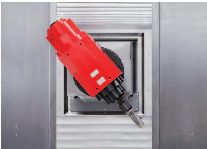
**Asse B:** l'asse B è azionato da un motore torque, in questo modo è possibile raggiungere un'elevata dinamicità nella corsa dell'asse grazie al raggio basculante di +/- 120 gradi.
