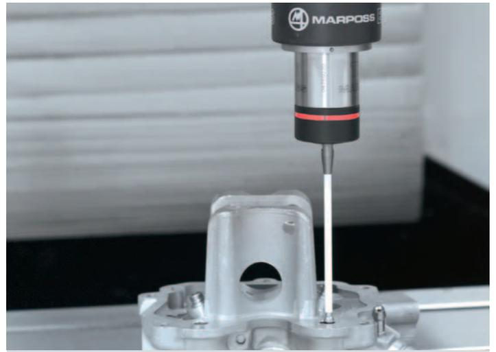
**Sistemi di misura.** Sistemi di misurazione utensili per la riduzione dei tempi di setup durante le operazioni di cambio utensile. Inoltre, misurazione pezzo per il controllo delle dimensioni o per il posizionamento degli zeri. La misurazione pezzo è radio.
