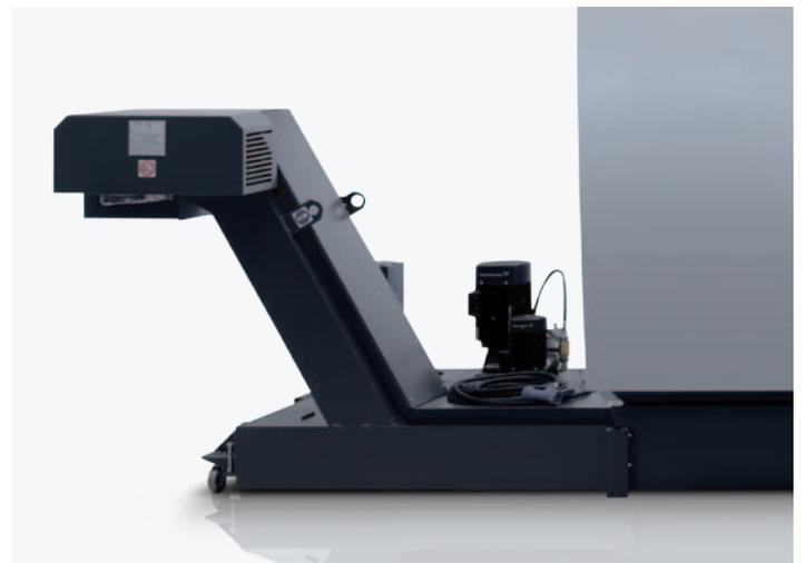
**Trasportatore trucioli a tapparella:** il sistema di evacuazione fa defluire i trucioli nel trasportatore trucioli a tapparella, il quale trasporta automaticamente i trucioli dall'interno della macchina al contenitore esterno opportunamente previsto dal cliente.
