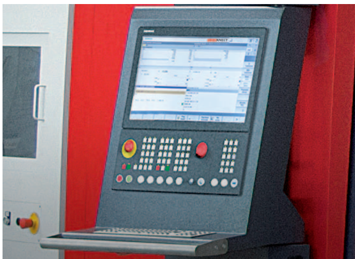
Base Hardware - monitor touch screen 22" in combinazione con un PC industriale (IPC)
